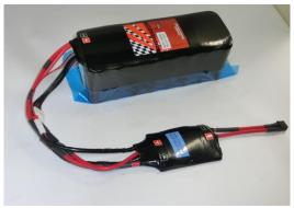
A123他リチウムイオン電池にPCM(Protection Circuit Module)を付けた電池パックを用意しております。
